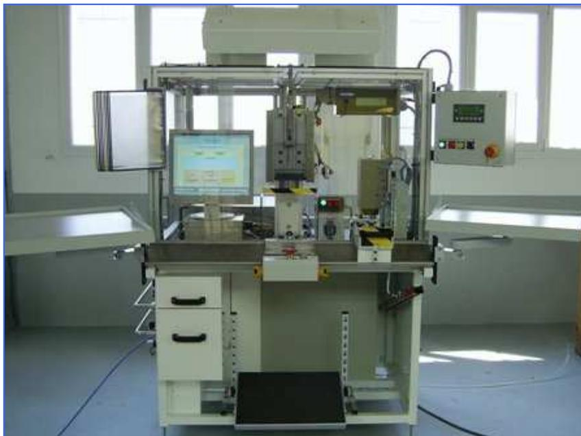
**POSTE DE CONTRÔLE ETANCHEITE INJECTEUR GAZ**
